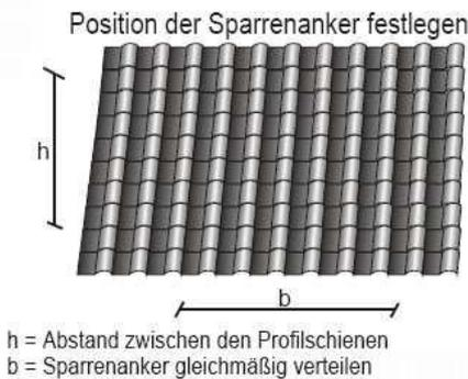
Abb. 2: Ausmessen der Dachfläche
